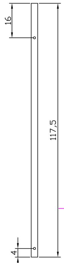
Alurohr 10 x 8 mm Lagerbüchsen aus 8 mm Alustange hergestellt und mit einem Buchsenkleber eingeklebt
